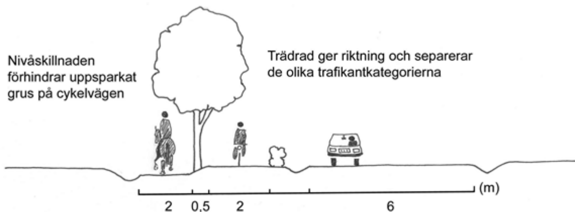
Figur 3. Ridväg bredvid gång och cykelväg
